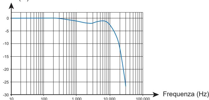
Curva tipica dell'errore di fase a 100A in funzione della frequenza
