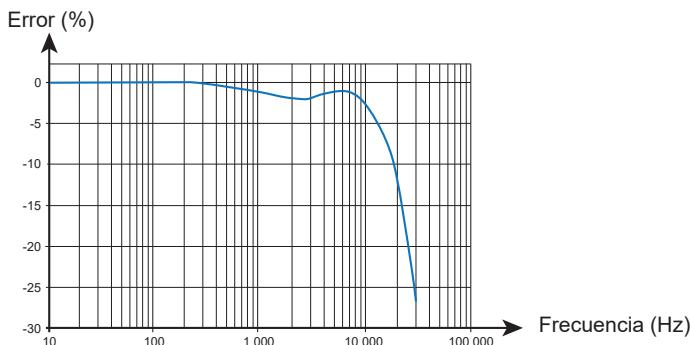
Curva típica del error de fase a 100 A en función de la frecuencia
