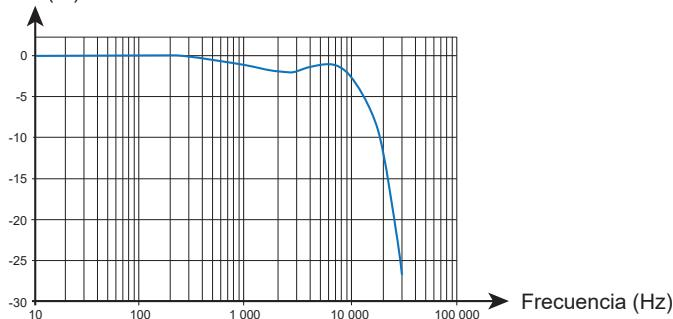
Curva típica del error de fase a 100 A en función de la frecuencia
