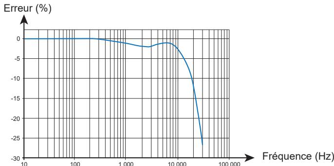
Courbe typique de l'erreur de phase à 100 A en fonction de la fréquence
